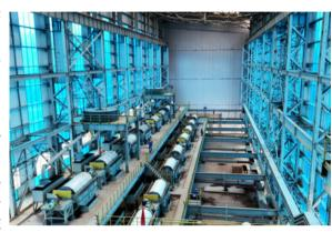
铁精矿 236 万吨。选矿工艺采用"半自磨-球磨-弱磁-再磨-弱磁-反浮选-浮尾再磨-弱磁"工艺流程,以现有 III 系列为基础,改造磨磁、反浮选、压滤系统,新建磁选车间、精矿搅拌槽、压滤给矿搅拌槽、磁精矿胶带转运系统,实现该系列处理红磁混合矿和闪石型原生矿的方便快捷切换。
