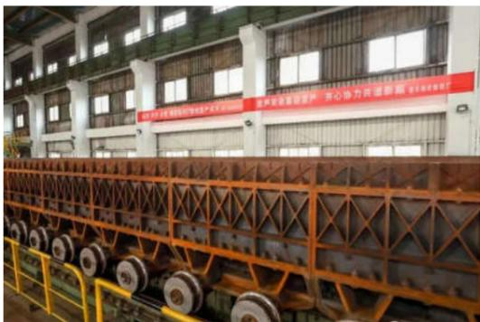
实际条件,对烧结机台车进行了拓宽,论证了环冷机热废气回收利用的可行性。设计改造后,烧结机利用系数≥1.37吨/平方米每小时,主要经济指标优于改造前水平。
